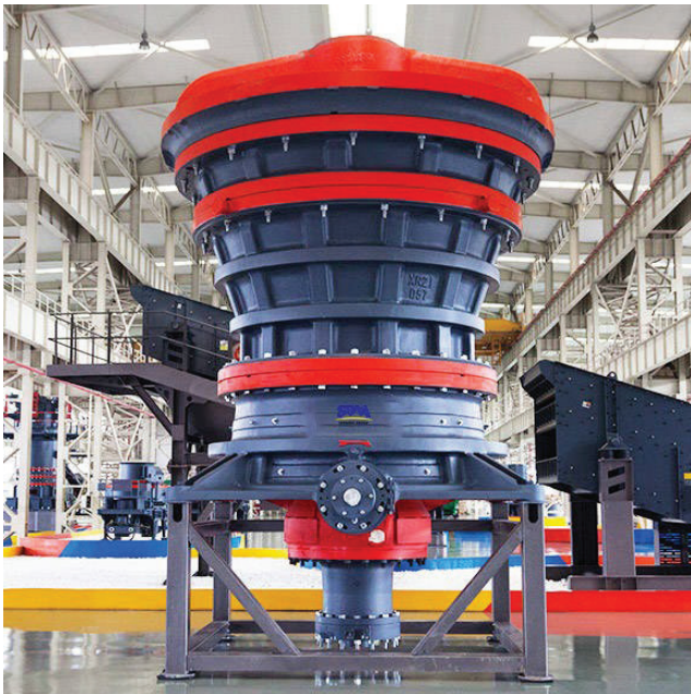
Рис. 4.30. Загальний вигляд гіраційної дробарки
