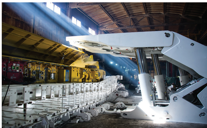
Рис. 1.19. Загальний вигляд вугільного комбайна разом з механізованим кріпленням
