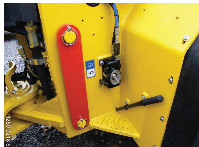
У транспортному положенні планка завжди є на машині
