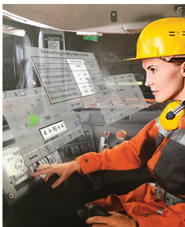
Рис. 1.43. Робоче місце прохідника в кабіні каретки S1D
