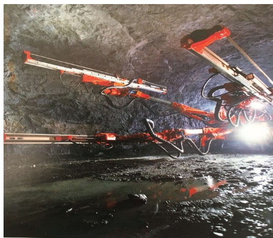
Рис. 1.44. Розташування бурових стріл каретки у вибої
