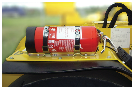
Вогнегасник розташований над переднім лівим колесом
