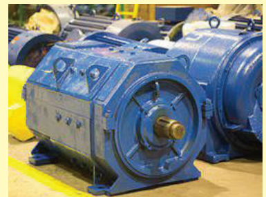
Рис. 5.11. Загальний вигляд тягового двигуна ДНТ-46 електровоза К-14
