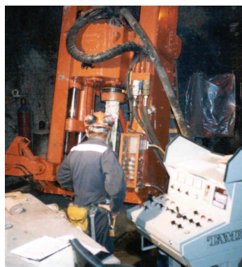
Рис. 1.50. Робоче місце проходника під час буріння «Ріно-400»
