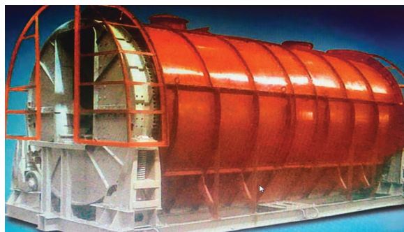
Рис. 5.18. Загальний вигляд перекидача ПКЕ-4/2 шахтних вагонеток ВГ-4,5
