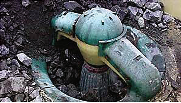
Рис. 4.31. Подрібнення сировини в гіраційній дробарці
