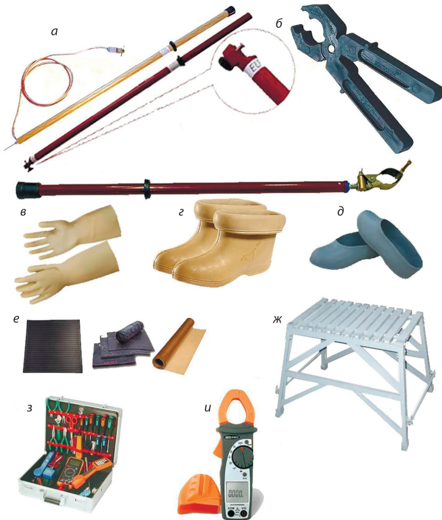
Рис. 4.23. Електрозахисні засоби, що застосовуються в електроустановках:
