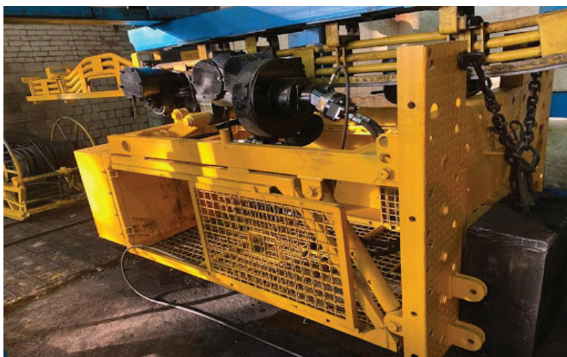
Рис. 1.47. Загальний вигляд прохідницького комплексу КПВ-1
