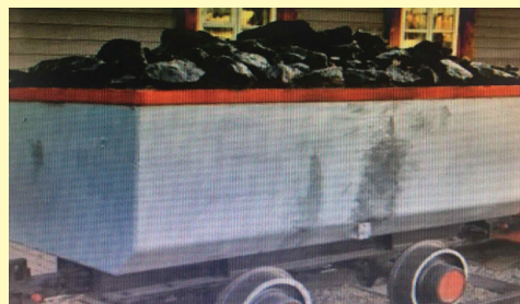
Рис. 5.5. Загальний вигляд шахтної вагонетки ВГ-4,5, завантаженої вугіллям
