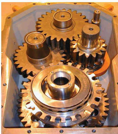
Рис. 1.52. Зубчасті щеплення у редукторі «Ріно-400н»
