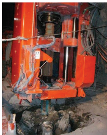
Рис. 1.51. Вихід бурового інструмента з підняття після завершення його буріння
