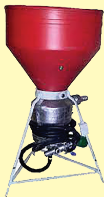
Рис. 1.27. Загальний вигляд зарядника ЗП-2 для заряджання шпурів і свердловин
