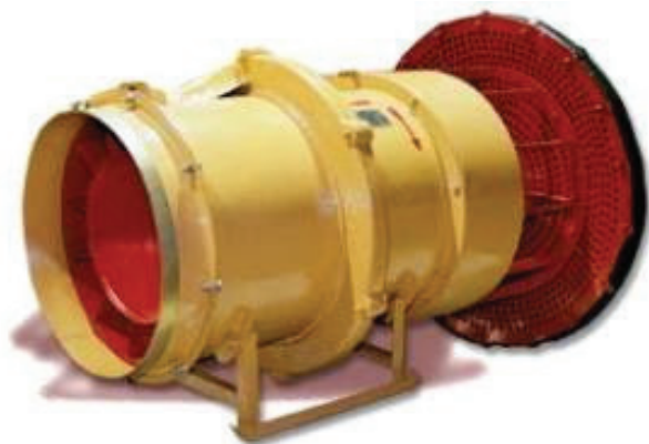
Рис. 4.5. Загальний вигляд привибійного вентилятора ВМП
